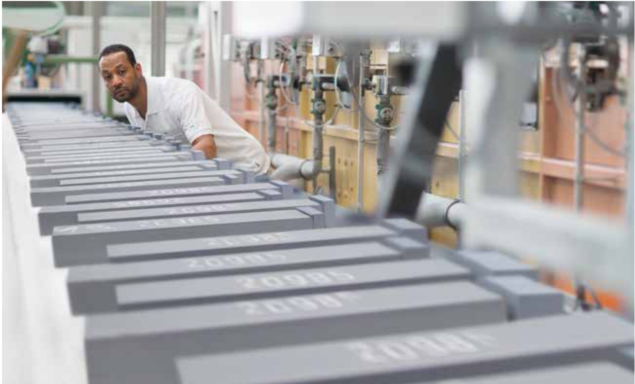
Saubere Sache: Die ElringKlinger-Tochter Hug produziert Keramiksubstrate aus Siliziumcarbid für ihre Dieselpartikelfilter.
