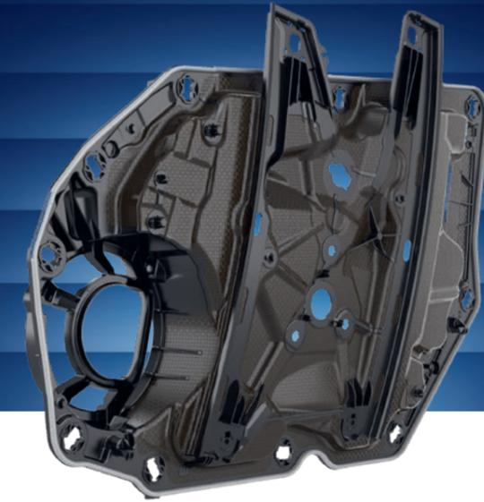
Der Türmodulträger wird in die Fahrzeugtür verbaut. An ihm werden Funktionselemente, wie der Fensterheber und das Schließsystem, befestigt. Bei der Herstellung der Türmodulträger werden besonders leichte und äußerst stabile Faserverbundwerkstoffe – sogenannte Organobleche – umgeformt und Kunststoffelemente für zusätzliche Bauteilfunktionen in einem Prozessschritt angespritzt.
